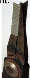
2. Mit einer Flachzange rechtwinklig biegen und auf das beiliegende 0,8mm Ms-Blech löten.
