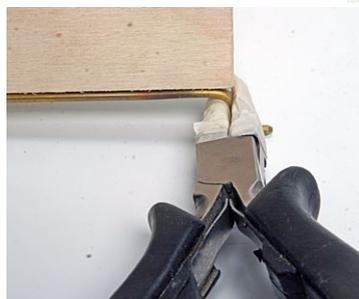
2. Flachzange mit Tesakrepp umwickeln. Abflussrohr (2mm Draht) mit einem Gasbrenner rotglühend erhitzen, mit der Flachzange fassen, mit einem Stück Sperrholz biegen und an die Regenrinne löten. Da der Draht durch das Erhitzen stark oxydiert, Oberfläche mit einem Glasradierer oder feinem Schleifpapier blank machen. Rohrschellen ca alle 30 mm anlöten.
