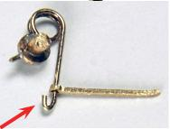
Inneren Überstand auf ca 1mm kürzen und flach feilen. Federfesthalter aufschieben und die Drahtschlaufe etwas zusammen biegen und kürzen (roter Pfeil).
