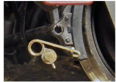
Bremsbacke unten mit 0,5mm Bohrer durchbohren, im Drehpunkt ca 1mm tief mit 1mm Bohrer nach Foto aufbohren, Lehre und Pinzette benutzen. Federfesthalter einfädeln, Feder einkleben und Federfesthalter umbiegen und kürzen. Federn vor dem Einbau schwarz lackieren.
