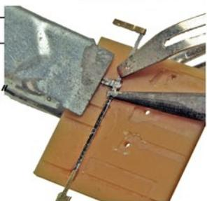
0,8mm Röhrchen auf 0,4mm Draht stecken und verlöten. Draht durch die Bohrung des Spannarms führen und verlöten.
