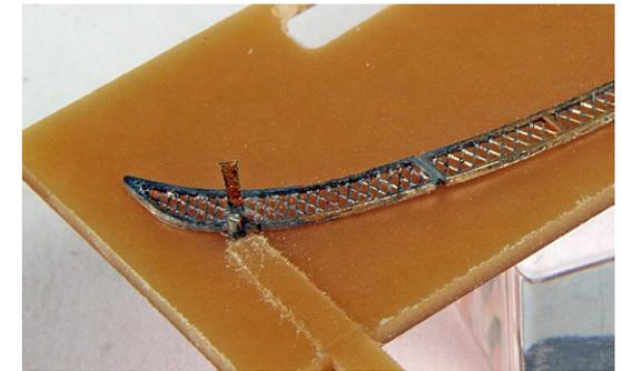
Signalhalter und Knotenbleche an den Rahmen (Gitter unten) löten.
