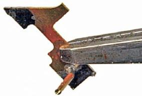
Gitterträger auf den Draht fädeln und im Abstand von ca 10mm festlöten. Spitzen der Gitterträger rundherum verzinnen und den Draht so biegen, dass der Träger senkrecht steht.
