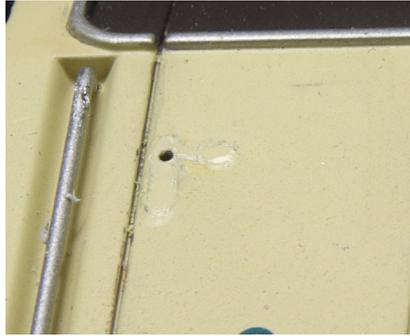
Mit Hilfe der Schablone 0,5mm Loch Bohren und die freigeschabten Stellen nachlackieren.
