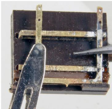
Trittstufenhalter an die Rahmen löten (einmal recht und einmal links). Verbindungstege abtrennen. Drahtbügel einlöten und nach Foto ablängen.
