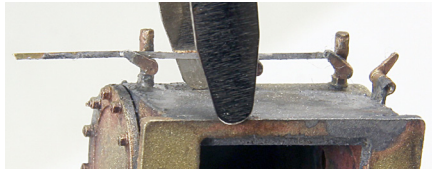
Zylinder aufbohren (0,6mm) und Entwässerungsventile (T22) einlöten. Die kleinen Zapfen auf den Hebeln der Ventile und der Umlenkungen vorher abfeilen. Die Grafik rechts (v. B. Pluntke) zeigt die prinzipielle Anordnung.
