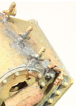
Zylinder aufbohren (0,6mm) und Entwässerungsventile (T22) einlöten. Die kleinen Zapfen auf den Hebeln der Ventile und der Umlenkungen vorher abfeilen. Die Grafik rechts (v. B. Pluntke) zeigt die prinzipielle Anordnung.
