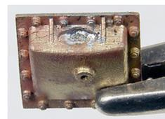
Schieberkastendeckel auch von außen nach Foto verzinnen und so anklemmen, dass sich die Bohrungen (0,6mm) für die Öler (werden später eingeklebt) mehr außen befinden.
