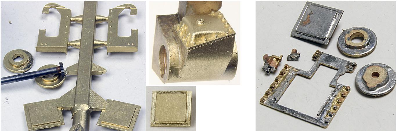
Zylinder- und Schieberkastendeckel (T 1, T 2 und T 3) vom Gussbaum trennen, vorher Angüsse nach Foto bearbeiten. Alle Deckel probeweise in den Zylinderkörper stecken und eventuell etwas nachfeilen. Zylinderplatten, Zylinder- und Schieberkastendeckel, hintere Schieberstangenstopfbuchsen und vordere Schieberstangenführungen verzinnen.
