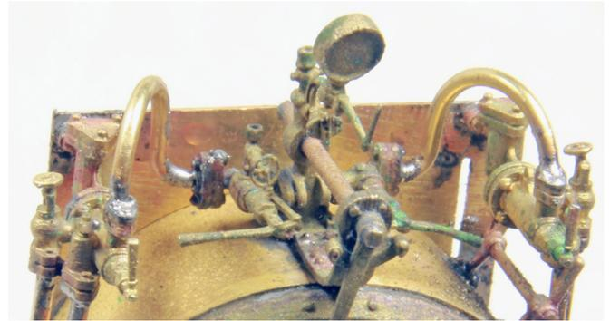
Verbindungsrohre (1mm Draht) nach Fotos biegen und anlöten.
