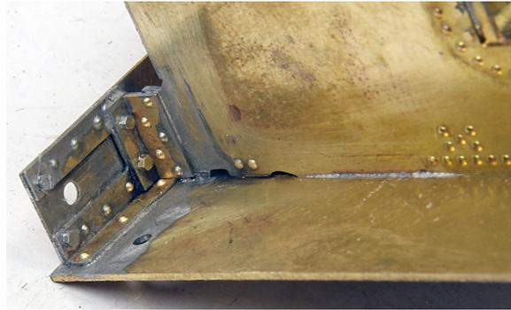
Waagerechte Schenkel (nur Nieten) der Winkelimitationen unter die Bodenplatte löten
