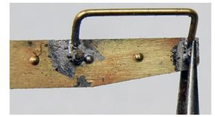
den äußeren stumpf in die äußere Bohrung löten, dabei Schraube mit einer Pinzette festhalten.
