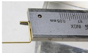
Rangierergriffe (0,6mm) biegen und einen Schenkel auf 4mm kürzen. Langen Schenkel schräg in die innere Bohrung löten, dann
