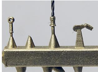
Bläserventil (T12) anbohren und an den Reglerdom löten. 0,4mm Draht zwischen Muffe und Ventil löten.
