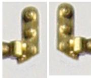
Die Scharniere nach Foto kürzen. Auf dem Rauchkammerblech befinden sich Bohrungen, in die die Zapfen der Scharniere einrasten (auf den Fotos in Kessel1 noch nicht zu sehen). Scharniere und Rauchkammerzentralverschluss anlöten. Scharnierbänder aufbohren und etwas nach vorne biegen, so dass die Tür flach aufliegt. Laternenhalter anlöten.
