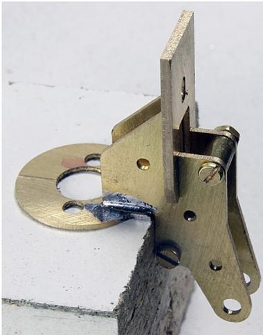
Die Seitenwangen werden nach Foto verschraubt, Schrauben nur mäßig anziehen. Trägerplatte ca 2mm aufschieben und die Spitzen mit einer Flachzange in die beiden Führungsnuten drücken. Trägerplatte bis zum Anschlag aufschieben. Schrauben anziehen. Motorhalter (genutet, zweiteilig) an die Seitenwangen löten. Getriebe gegen eine ebene Unterlage drücken und Lötstellen nochmal erwärmen, so dass sich beide Teile plan ausrichten.
