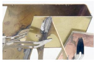
Kohlenkastendeckbleche werden spiegelbildlich ausgeführt. Im Bereich der Pfeile so nachfeilen, dass der Überstand des Bleches seitlich und vorne gleich ist. Bleche nach Foto im Führerhaus an die Seitenwand, dann an die Stirnwand löten. Vorderen Teil verlöten. Innere Bleche an die Stirnwand löten. Die restlichen Kanten von außen verlöten.
