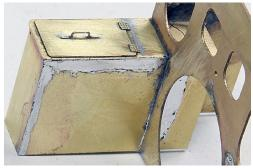
Die Führerhauskanten werden jetzt befeilt und geschliffen. Hierbei ist eine Spanplatte, auf die Schleifleinen mit Teppichklebeband geklebt wurde, hilfreich. Die Kanten leicht brechen.
