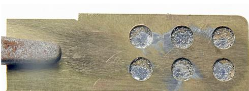
Klappenscharniere (Gussteile T 18) verzinnen, an Vierkant löten und abtrennen. Angusstellen befeilen und an die Klappe löten.
