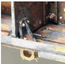
Wellenlager (T3) anlöten. Untere Gleitbacken provisorisch an die Steuerungsträger löten. 0,6mm Ns-Draht in die Bohrungen der Umsteuerwelle löten. Welle einsetzen.
