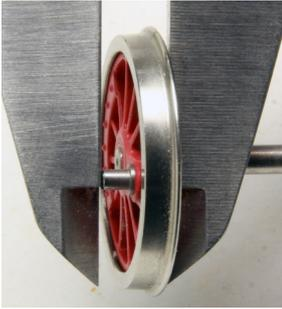
Zur weiteren Montage müssen die Radsätze eingesetzt werden (siehe Getriebe 2). Hilfreich ist, die Pilzkontakte mit den Klemmen innen zu fixieren (siehe Pilzkontakte). Vorher die Buchsen der äußeren Radsätze auf 4,7mm (Buchse plus Radbreite) abfeilen.
