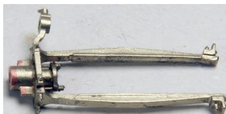
Gleitbackengussteil anpassen, im roten Bereich abfeilen. Zylinder aufbohren
