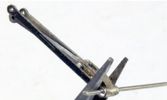
Die inneren Kanten der beiden längeren Hebel abrunden. Zuerst den kürzeren, dann die beiden längeren Ns-Hebel mit der Wippe verbinden (0,6mm Ns- Draht). Kleineren Hebel am Ende dünner feilen, so dass er in Schieberschubstange passt.
