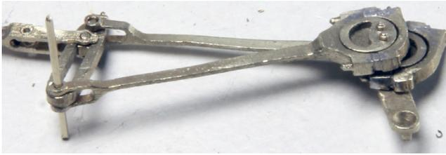
Äußere Excenterstange unten mit der Wippe verbinden (0,6mm Ns-Draht, noch nicht kürzen), Gabel der inneren Excenterstange soweit aufreiben, dass sie in die Zapfen der Wippe einrastet.
