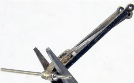
Zuerst den kürzeren , dann die beiden längeren Ns-Hebel mit der Wippe verbinden (0,6mm Ns- Draht). Kleineren Hebel am Ende dünner feilen, so dass er in Schieber- schubstange passt.
