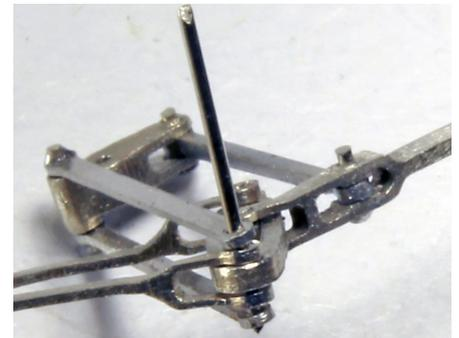
Kl. Hebel mit der Zylinderschubstange verbinden. Die beiden äußeren Hebel mit der Wipp verbinden, dazu Draht hin und her schieben. Beidseitig verlöten.
