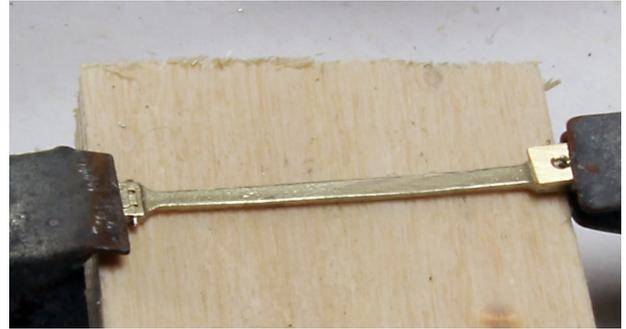
Kreuzköpfe durchbohren (1mm). Am runden Ende der Treibstange Zapfen kürzen, Treibstange in den Kreuzkopf stecken und durchbohren. 1mm Bohrer durchstecken und Ausschlag ( je 9 mm) testen. Schraube (T13) von hinten verlöten und plan feilen. iKolbenstange auf 21mm kürzen.
