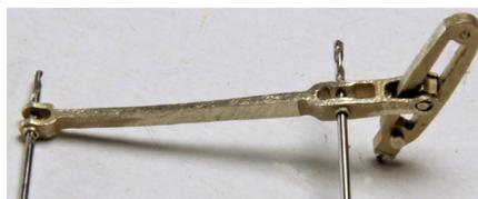
Zwei 0,6mm Bohrungen (die Schwinde wird später motiertiert).
