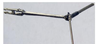
Vorderteil der Schieberzugstange und Schwinde vor dem Abtrennen im Gussbaum aufbohren (0,6mm)
