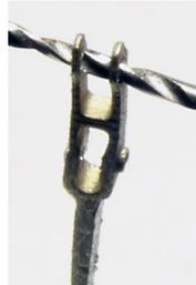
Vorder- und Hinterteil der Schieberzugstange werden durch einen 0,6mm Ns-Draht miteinander verbunden. Scharnierbohrungen eventuell aufreiben. Einseitig löten.
