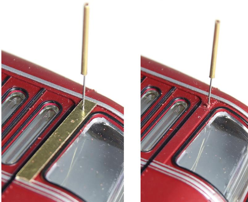
Löcher ca 0.5mm tief anbohren, Bohrlehre entfernen und durch die Wand bohren.
