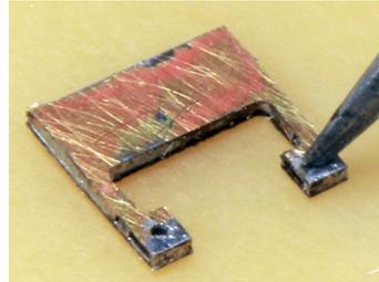
Dünnes Blech nach Foto verzinnen (etwas weniger Lot tut es auch). Beide Teile an der oberen Kante zusammen löten. Den eigentlichen Signalhalter mit einem spitzen Gegenstand zusammendrücken und mit dem Kolben erweärmen. V-förmig gebogenen Draht in die beiden Bohrungen löten. Signalhalter mit einem scharfen Seitenschneider ohne Wate abtrennen und versäubern.
