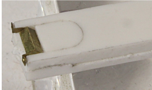
Mit 2K-Kleber (z. B. UHU plus schnellfest) an die Pufferhülse kleben. Nach dem Aushärten Klebehilfe nach unten drücken und entfernen.
