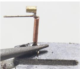
Hebel an einen abgewinkelten 0,3 Draht löten, Spirale und Klammer aufschieben und verlöten. Beide Federklammern sind gleich, nur bei einer bleibt der Draht länger, um das Lackieren zu erleichtern.
