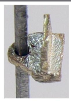
Stangenlager und Hebel auf eine Reibahle stecken und Frässtege entfernen.
