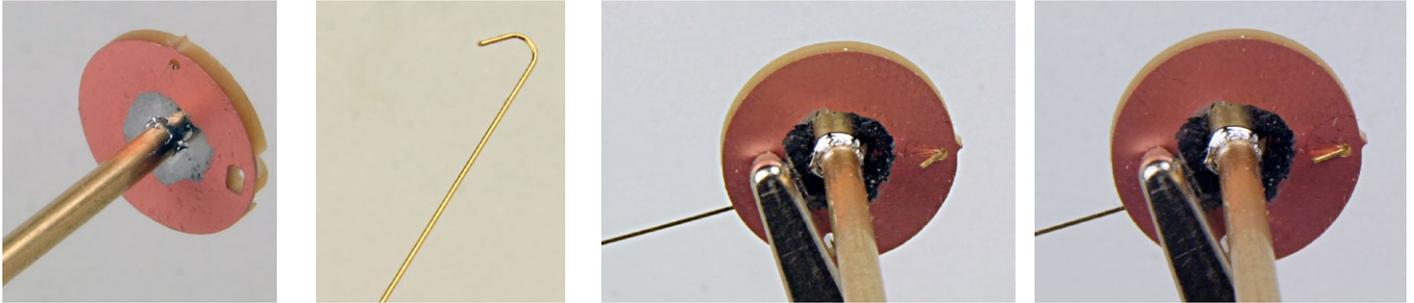
Pertinaxscheibe auf das Ms-Rundmaterial löten. 0,3mm Drahtende zu einem Haken biegen und in die Lehre hängen. Haken flach biegen.
