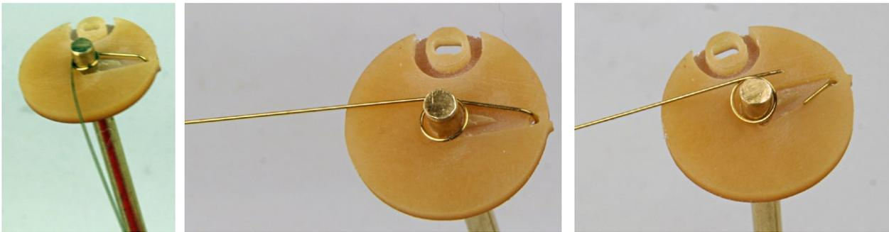
Rundmessing drehen und gleichzeitig den Draht fest ziehen, so dass er sich stramm um das Rundmessing wickelt. Das mittlere Foto zeigt den entspannten Zustand. Haken abtrennen.
