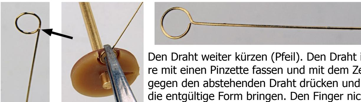
Den Draht weiter kürzen (Pfeil). Den Draht in der Lehre mit einer Pinzette fassen und mit dem Zeigefinger gegen den abstehenden Draht drücken und ihn so in die entgültige Form bringen. Den Finger nicht zu dicht an der Öse ansetzen, sonst besteht die Gefahr, dass er bricht. Ist die Biegestelle nur angebrochen, lässt sie sich durch wenig Lot stabilisieren.
