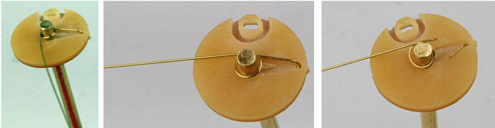
Rundmessing drehen und gleichzeitig den Draht fest ziehen, so dass er
