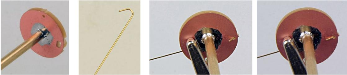
Pertinaxscheibe auf das Ms-Rundmaterial löten. 0,3mm Drahtende zu einem Haken biegen und in die Lehre hängen. Haken flach biegen.
