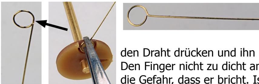
Den Draht weiter kürzen (Pfeil). Den Draht in der Lehre mit einer Pinzette fassen und mit dem Zeigefinger gegen den abstehenden Draht drücken und ihn so in die entgültige Form bringen. Den Finger nicht zu dicht an der Öse ansetzen, sonst besteht die Gefahr, dass er bricht. Ist die Biegestelle nur angebrochen, lässt sie sich durch wenig Lot stabilisieren.
