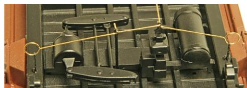
Diese Fräsplatte reicht aus, um fünf Fahrgestelle zu bestücken. Die Einzelteile werden in 0,6mm Bohrungen gesteckt und mit Sekundenkleber gesichert. Dann werden die Drahte mit den entsprechenden Lehren gebogen, eingefädelt und ebenfalls mit Sekundenkleber gesichert. Verbindungsdrähte schwarz, Ösen rot lackieren.
