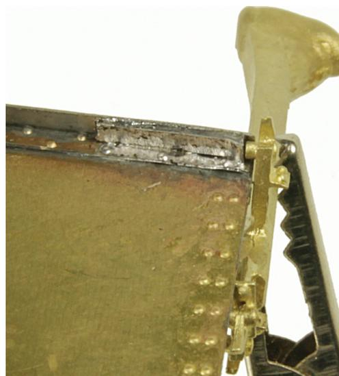
Innere Teilstücke der Klappengelenke einlöten. Entsprechendes Gussteil (Zapfen sind unterschiedlich lang) als Abstandsmaß nehmen.
