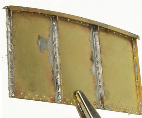
Oberes T- Profil in die Nut des Nietbandes löten. Mittelstücke der senkrechten I-Profile in die Nuten löten.
