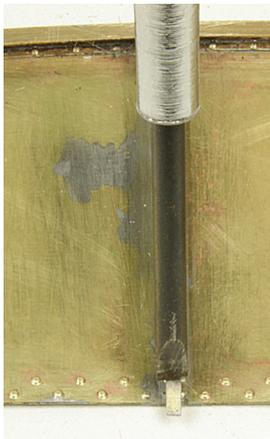
Mit einem Schraubendreher Ms-Streifen gegen das profilierte Ende des Mittelstückes drücken und verlöten.
