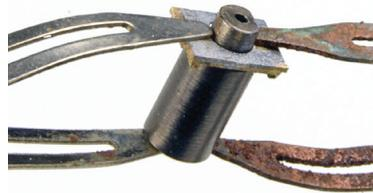
Pufferhülse befeilen und an die Pufferplatte löten.
