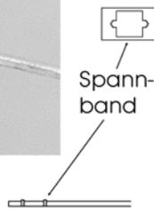
Pfosten in einen Schraubstock spannen und mit beiliegendem höherschmelzendem Lot an drei Seiten im oberen Bereich verzinnen. Nebenstehendes Ätzteil um den Pfosten knicken, mit einer Stecknadel leicht nach unten drücken und mit Lötwasser einstreichen. Pfosten mit dem Kolben erhitzen und überflüssiges Lot dort hin ziehen, wo es sich leicht abfeilen läßt.
