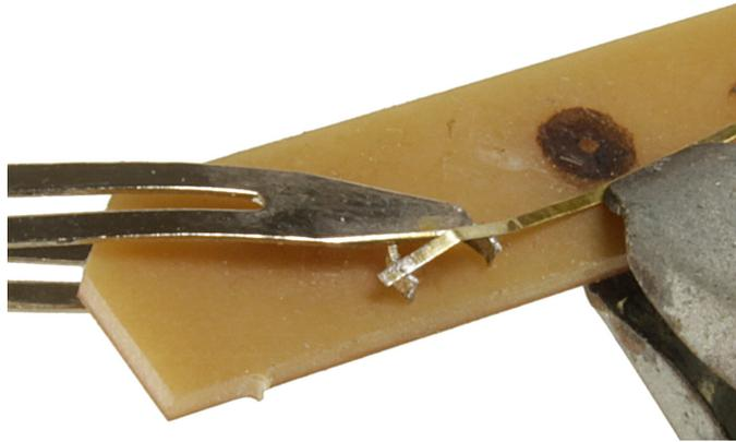
Die Abdeckung der äußeren Scheiben wird erst nach der Lackierung und Montage der Seile aufgeklebt. Zum leichteren Lackieren wird ein Ende des Bügels noch nicht abgetrennt.
