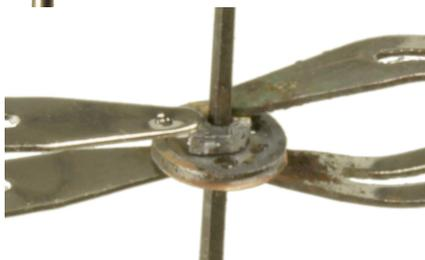
Die beiden inneren Seilscheiben (je 3 Teile) auf 1,2mm Draht so aufstecken, dass die drei Bohrungen übereinander liegen. Möglichst rechtwinklig mit dem Draht verlöten oder im Bohrfutter die Scheiben mit dem heißen LötKolben nachdrücken. Mit einer Dreikantfeile die Nut erweitern. Seilscheiben mit dem Kolben auf eine Unterlage drücken und den Draht mit einer Pinzette herausziehen.
