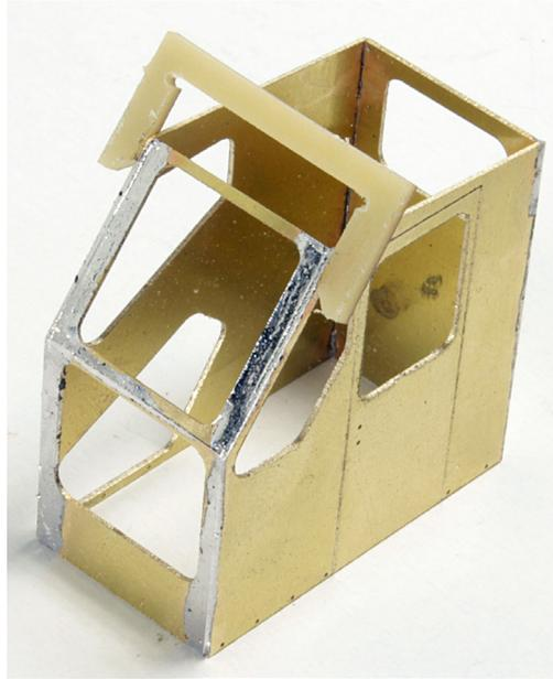
Obere Stirnwand oben und unten ab-schrägen (schmale Seiten) und zwischen die Seitenteile und an die untere Stirnwand löten.
