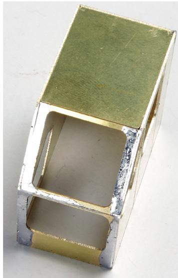
Die vier Ecken des Daches leicht abrunden, von unten positionieren und von außen verlöten.
