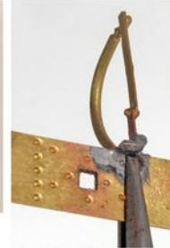
2. Anstelle der beiliegenden Kunststoffbremschläuche können Sie auch Ms- Bremschläuche an die Pufferbohle löten. Brems Schlauchhalterung von hinten verzinnen, "Niete" auf der Pufferbohle (Foto oben) abschleifen und Pufferbohle beidseitig im schraffiertem Bereich verzinnen. Brems Schlauch mit einer Pinzette halten und Pufferbohle von hinten erwärmen. Mit der zweiten Pufferbohle spiegelbildlich verfahren.
