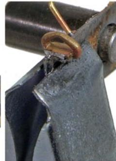
4. Gussteil verzinnen, erste Zurröse abtrennen und Schnittkante glätten. Die auf dem Gussteile verbliebene Schnittfläche ebenfalls plan feilen, zweite Zurröse abtrennen u.s.w.. Winkel von hinten auf die Pufferbohlen löten, darauf die Zurrösen.
