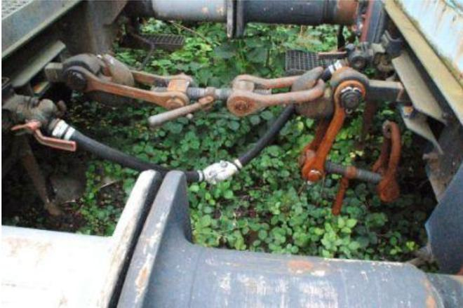
Durch diese Art der Anordnung der Kupplungen für die Hauptluftleitung können die Verbindungen der Waggon sowohl gegenüber als auch diagonal miteinander gekuppelt werden.
