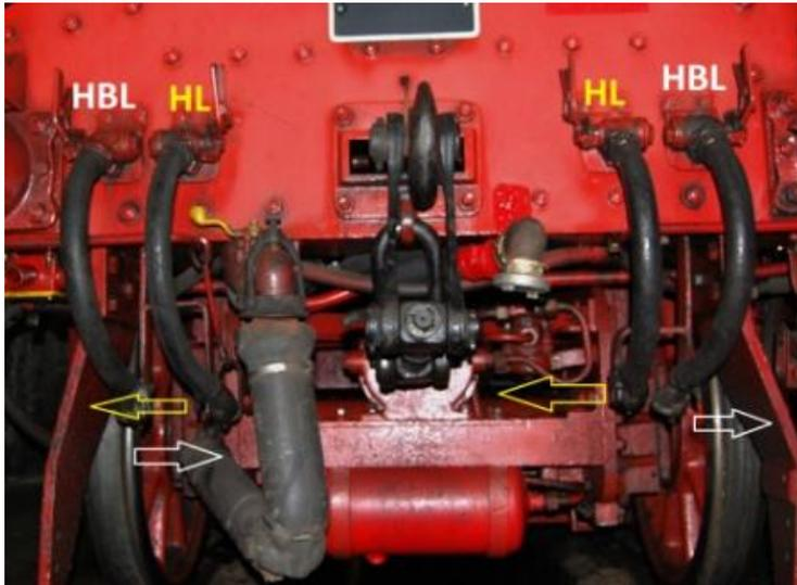
Die Anschlüsse der äußeren HBL zeigen immer nach rechts, die Anschlüsse der inneren HLL zeigen immer nach links!
