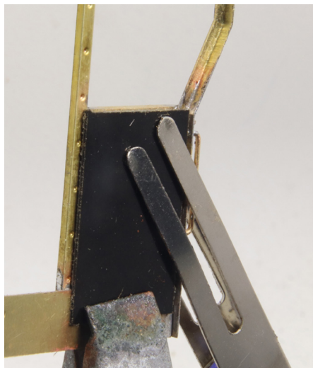
U-Profile an die Pufferbohle löten.
