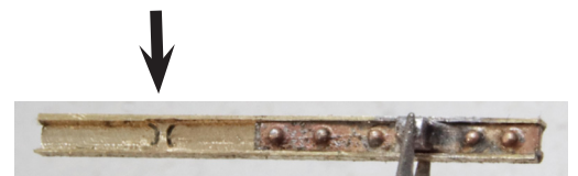
Spindelsockeln in das U-Profil löten.
