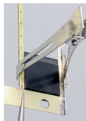
Außenholme an die Pufferbohle löten.
