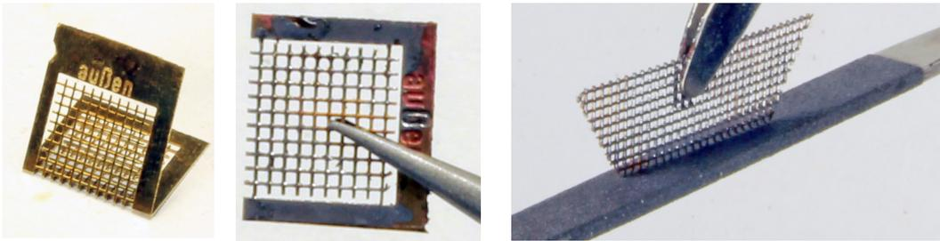
Gitter zusammenfalten, verlöten und mit der Schere aus dem Rahmen trennen. Ränder vorsichtig befeilen, dann ohne Zugabe von Lot (aber reichlich Lötwasser verwenden) in die Rahmen löten.
