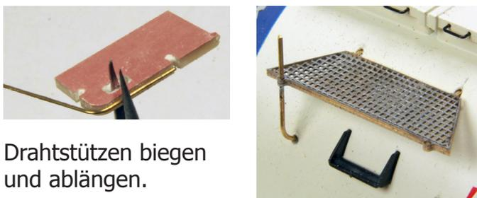
Drahtstützen biegen und ablängen.
