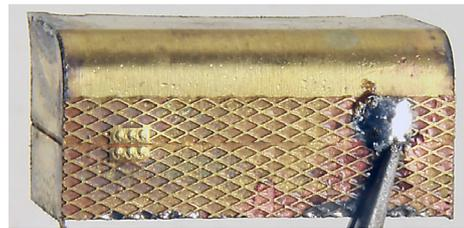
Draht 0,3x2mm in die Scharnierrille legen, noch kein Lötwasser benutzen. Draht mit einer Pinzette fixieren, jetzt mit Lötwasser benetzen und anlöten. Überflüssiges Lot mit dem Kolben nach vorne ziehen und damit das Riffelblech anlöten. Jetzt die Pinzette loslassen und den zweiten Draht anlöten.
