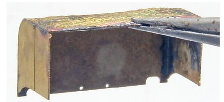
Riffelblech leicht biegen und von hinten bündig anlöten.
