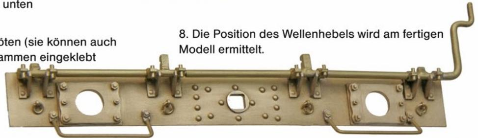
Die unteren Trittstufenhalter werden beim Vorbild (K06, O02) von der hinteren Pufferbohlenseite nach vorne geführt. Beim K06 sind beide Tritte an einer Stirnwand angeordnet, beim Kohlenwagen jeweils eine diagonal gegenüber der Wellenhebelseite.
