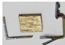
9. Stoßkante mit hochschmelzendem Lot verzinnen und auf das Trittbrett löten. Trittbrett auf den Halter löten, Halter auf die Pufferbohle. Eine nasse Wattewurst in die Zurröse stecken und Trittstufe von hinten an die Pufferbohle löten.
