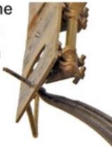
5. Zwei 0,5mm Drähte neben die Biegelehre legen, darauf den 0,5mm Draht für den Griff. Draht und Lehre mit einer Flachzange fassen und Draht mit einer Feile biegen. Rangierergriffe von hinten anlöten. Biegelehre oder Wellenlagerlehre als Abstandslehre benutzen. Darauf achten, dass das Lot vorne heraus tritt. Griffe nach unten biegen und Haltetaschen anlöten, ohne neues Lot hinzuzufügen.
