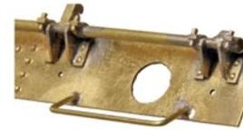
7. Pufferplatten anlöten (sie können auch mit den Puffern zusammen eingeklebt werden).
