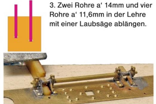
3. Zwei Rohre a' 14mm und vier Rohre a' 11,6mm in der Lehre mit einer Laubsäge ablängen.
