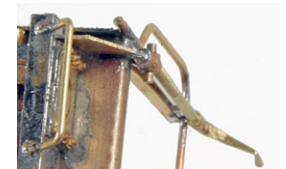
16. Spindel auf den Sockel und an das Geländer löten.
