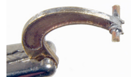
17. 1mm Draht und zwei 0,3mm Scheiben an die Sichel löten. Frässtege der Scheiben abfeilen.
