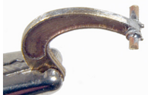
16. 1mm Draht und zwei 0,3mm Scheiben an die Sichel löten. Frässtege der Scheiben abfeilen.
