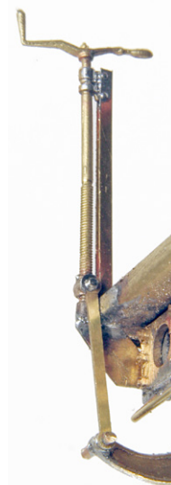
17. Sichel einhängen und innere Zuglasche an den Spindelsockel und an die Sichel löten.
