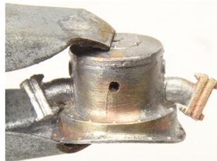
Lackieren des Kessels unlackiert einkleben. Überstromrohrflansche (T18) anlöten. Vorher Zapfen kürzen und befeilen. Reglerdom auflöten, Abstand zum Kamin 19mm Mitte zu Mitte. Flansche mit nasser Watte kühlen.
