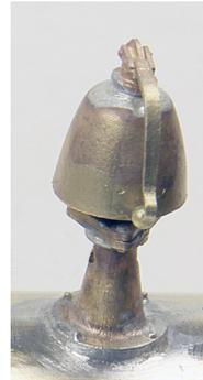
Glockenflansch (T7) und Glocke (T5) auflöten. Schwengel rechts (T12) auflöten.
