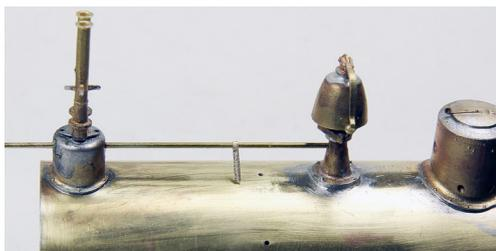
Steuerstange (0,8mm Draht) durch die Ventilverkleidung stecken, Flansch aufschieben und Draht bis vor den Reglerdom schieben. Rohrflansch (T12) aufstecken und verlöten.
