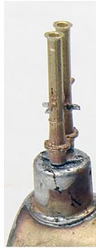
Sicherheitsventilverkleidung (T7), Glockensockel (T7), Sanddom (T5) und Reglerdom (T5) vor dem Einbau durchbohren (0,8mm). Teile von innen verzinnen und von oben erwärmen. Sicherheitsventil (T7) auflöten.
