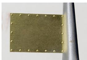
Kessel hinten so unterlegen, dass er parallel zur Unterlage ist. Deckbleche von hinten mit den Lochblechen unterfüttern, so wird ein eventuelles Ausbeulen beim Sandstrahlen vermieden. Oben abschrägen, mit einer Flachzange den oberen Rand etwas nach innen biegen und auflöten.
