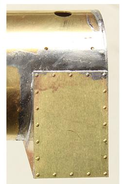
Kessel vorne unten mit Schieblehre (22,3mm) anreißen und Stützblech anlöten. Zweites Blech ca 2mm vom Rand entfernt anlöten. Deckbleche oben anschrägen und 1,6mm vom Rand entfernt auflöten. Vordere Kante rund feilen.
