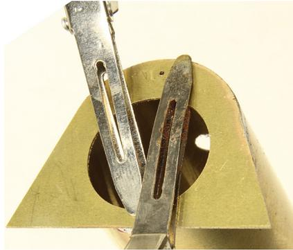
In den Kessel vorne und hinten Ringe löten. Zuerst den vorderen einlöten, wobei der hinter auch schon positioniert sein muss. Mittleren Ring einlöten,
