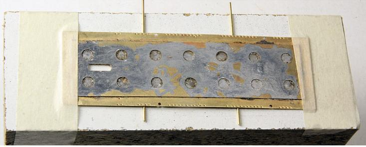
Wasserkastendeckelverstärkung von unten auf den Wasserkastendeckel löten. Mit zwei 0,8mm Drähten das Ganze zu einem leichten Bogen formen, das verhindert, dass sich der Wasserkastendeckel, der später vorne und hinten niedergedrückt wird, sich in der Mitte aufwirft.
