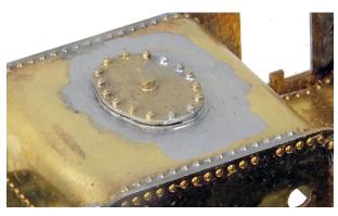
Mannlochverschluss zusammen löten und auf den Wasserkastenboden löten.
