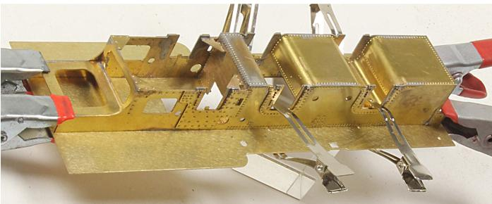
Umlauf entgraten, sorgfältig ausrichten (Überstand vorne und hinten gleich) und an zwei diagonal gegenüberliegenden Punkten anheften. Lage überprüfen und den Umlauf von innen auf den Rahmen löten
