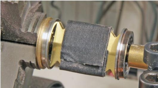
Auf das bearbeitete Rad Ring (Falz zum Rad) und Scheibe stecken, nach Foto einspannen und das andere Rad bearbeiten.
