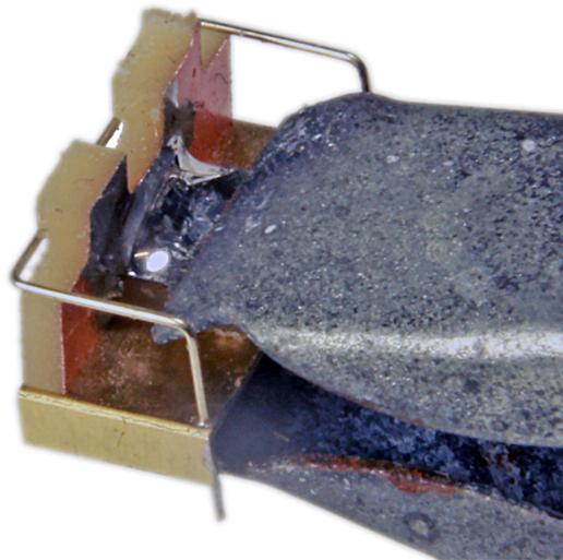
Bügelstützen, wahlweise eine, zwei oder drei stumpf an den Bügel löten, dann an die Sitzfläche.
