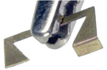
Bügelunterteile, die auf Knotenbleche gelötet werden, entsprechend kürzen.
