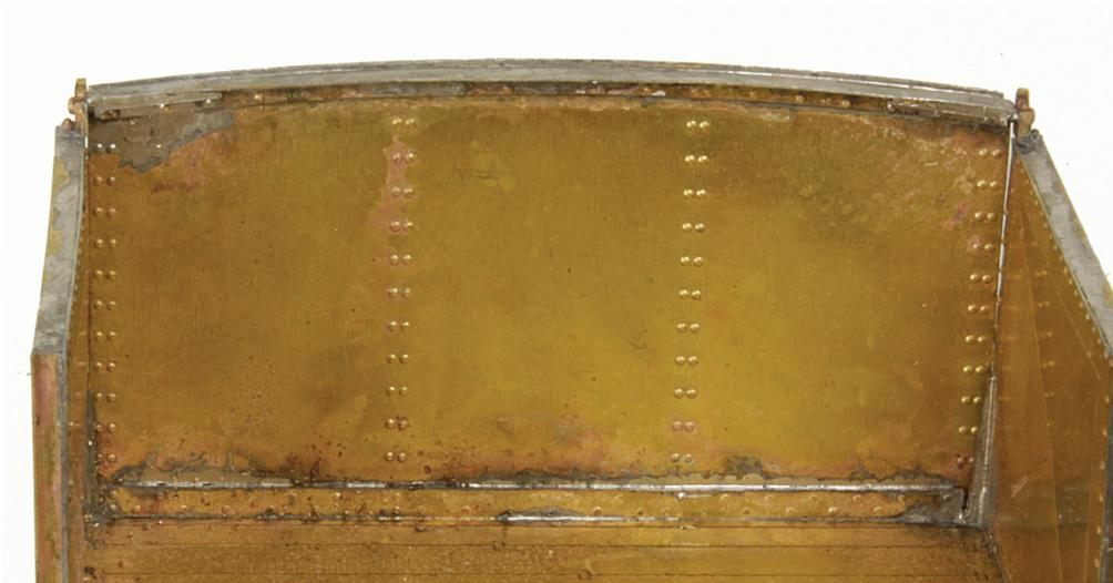
Stirwandklappen von innen am unteren Nietband und den Klappengelenken verlöten.
