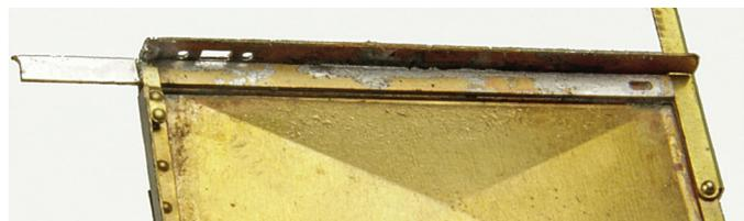
Schubstange anlöten, Abstand zur oberen Kante ist die Türriegelbreite, diesen erst nach Montage der Scharniere anbringen.
