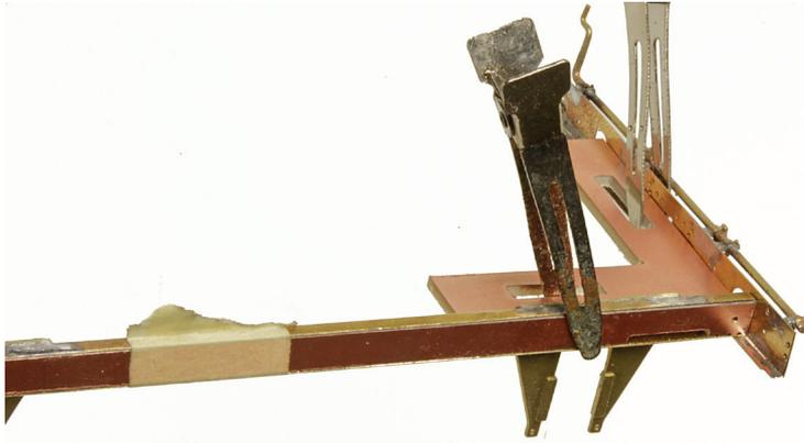
Zapfen der Langträger von außen an die Pufferbohlen löten, dazu Abstandslehre genau mittig im Langträger mit Klebeband fixieren. Zweiten Langträger anlöten.
