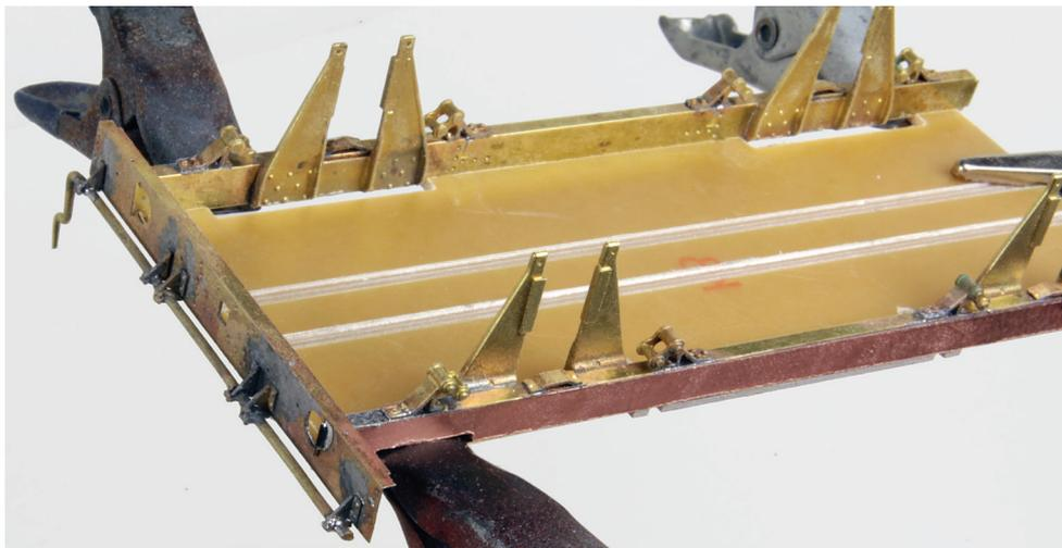
Große Fahrwerksplatine fixieren und zweite Pufferbohle anlöten. Abstandslehre muss anliegen! Eckknotenbleche anlöten. 3,5m Achsstand-Fahrwerk: Äußere Schakenböcke nach Foto biegen und auf Knotenbleche und Langträger löten.
