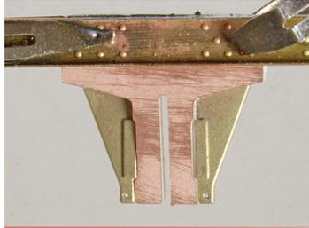
Achshalter anlöten. Beim 3m Achsstand-Fahrwerk auch die Schakenböcke anlöten.
