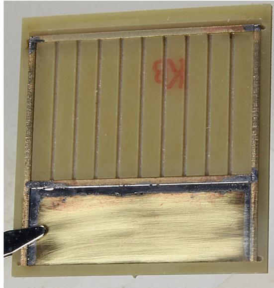
Unteren Querholm (nur angebohrt) auf das Blech und an die Seitenholme löten. Oberen Querholm (durchbohrt) an die Seitenholme löten. Rahmen aus der Lehre nehmen, Draht von oben durchstecken und oben und unten verlöten.
