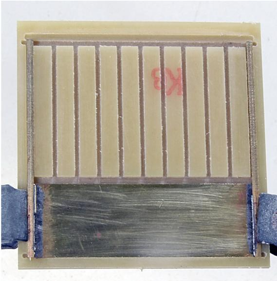
Die beiden Seitenholme stumpf an das Blech löten.
