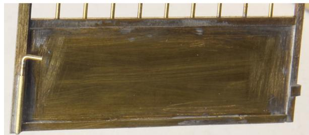
An den anderen Flügel Anschlagstreifen löten, darauf Rohr für den Feststeller löten. An beide Flügel beidseitig untere Verstärkungstreifen löten. Vier Scharniere im Abstand von 4mm zu den Ecken anlöten.
